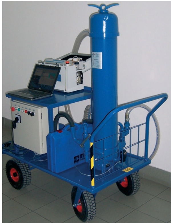
Fot. 8. Agregat filtracyjny produkcji firmy BIBUS MENOS typ MHL-BM800
