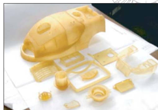
Zanim odkurzacz trafił na półki sklepowe, jego prototyp został wydrukowany w postaci elementów składowych, a następnie złożony w celu przeprowadzenia testów
