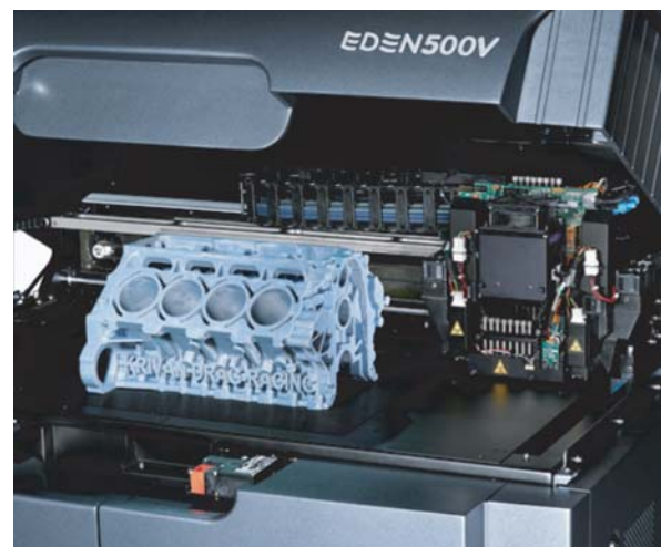
Przykładem zastosowania rapid prototyping w branży motoryzacyjnej jest wydrukowany przez nas model silnika Forda...
