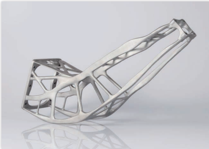
Rys. 4 Wspornik anteny satelity obserwacyjnego wykonany metodą przyrostową ze stopu AlSi10Mg. Detal ten został zaprojektowany z wykorzystaniem optymalizacji topologicznej, przez co udało się odciążyć oryginalny projekt o 40%, przy zachowaniu 30% zapasu sztywności tego komponentu. (źródło: RUAG i EOS).
