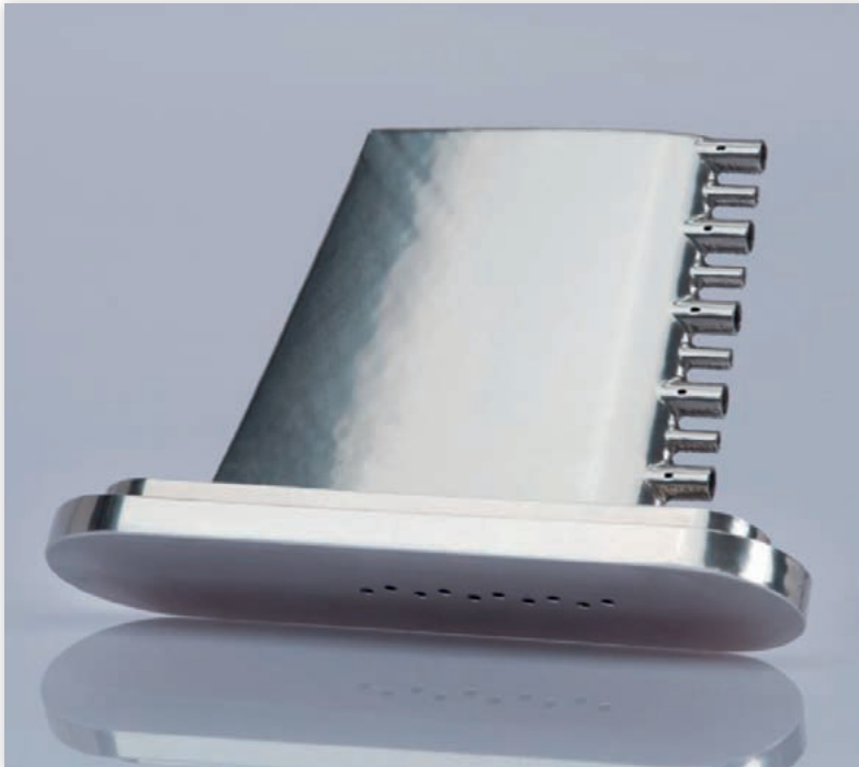
Rys. 2 Sonda firmy Vectaflow mierząca przepływ gazów w lotniczych silnikach turbinowych. Dzięki zastosowaniu technologii druku 3D z metalu udało się obniżyć jej masę i jednocześnie zwiększyć precyzję pomiaru, poprzez zastosowanie kanałów o zoptymalizowanej geometrii bez konieczności wiercenia (źródło: Vectaflow i EOS).
