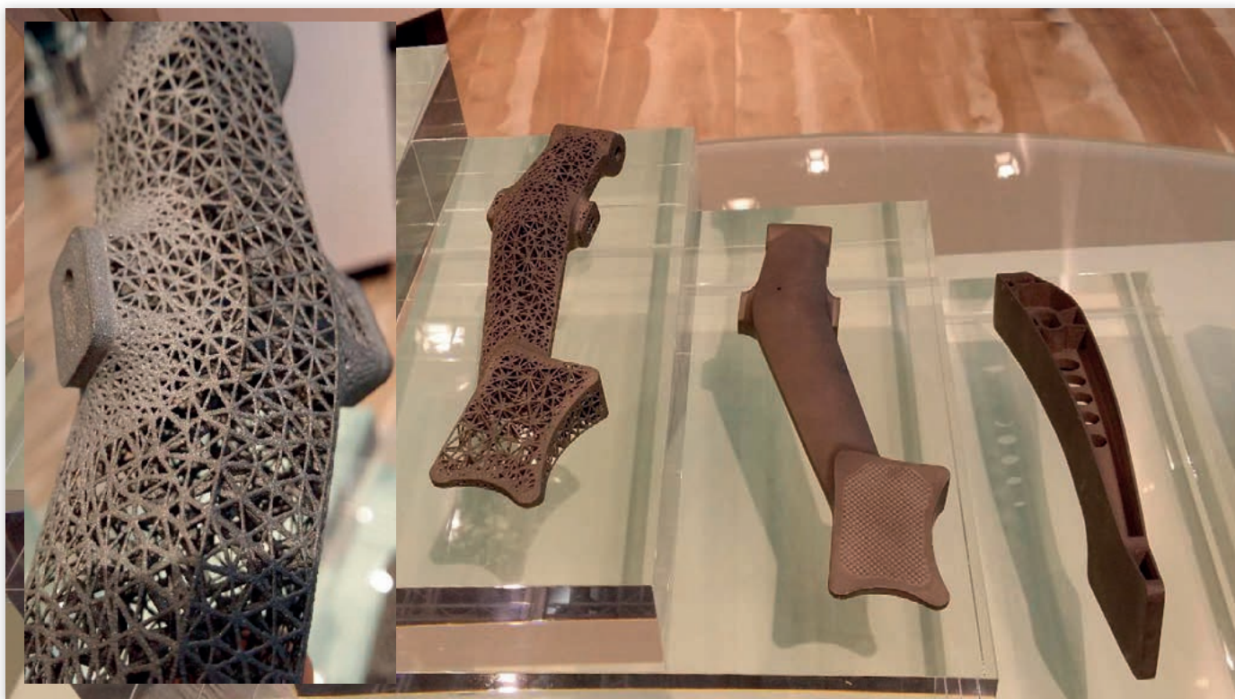
Rys. 1 Przykład odciążonej konstrukcji aluminiowego pedału lotniczego wykonanego w technologii DMLS
