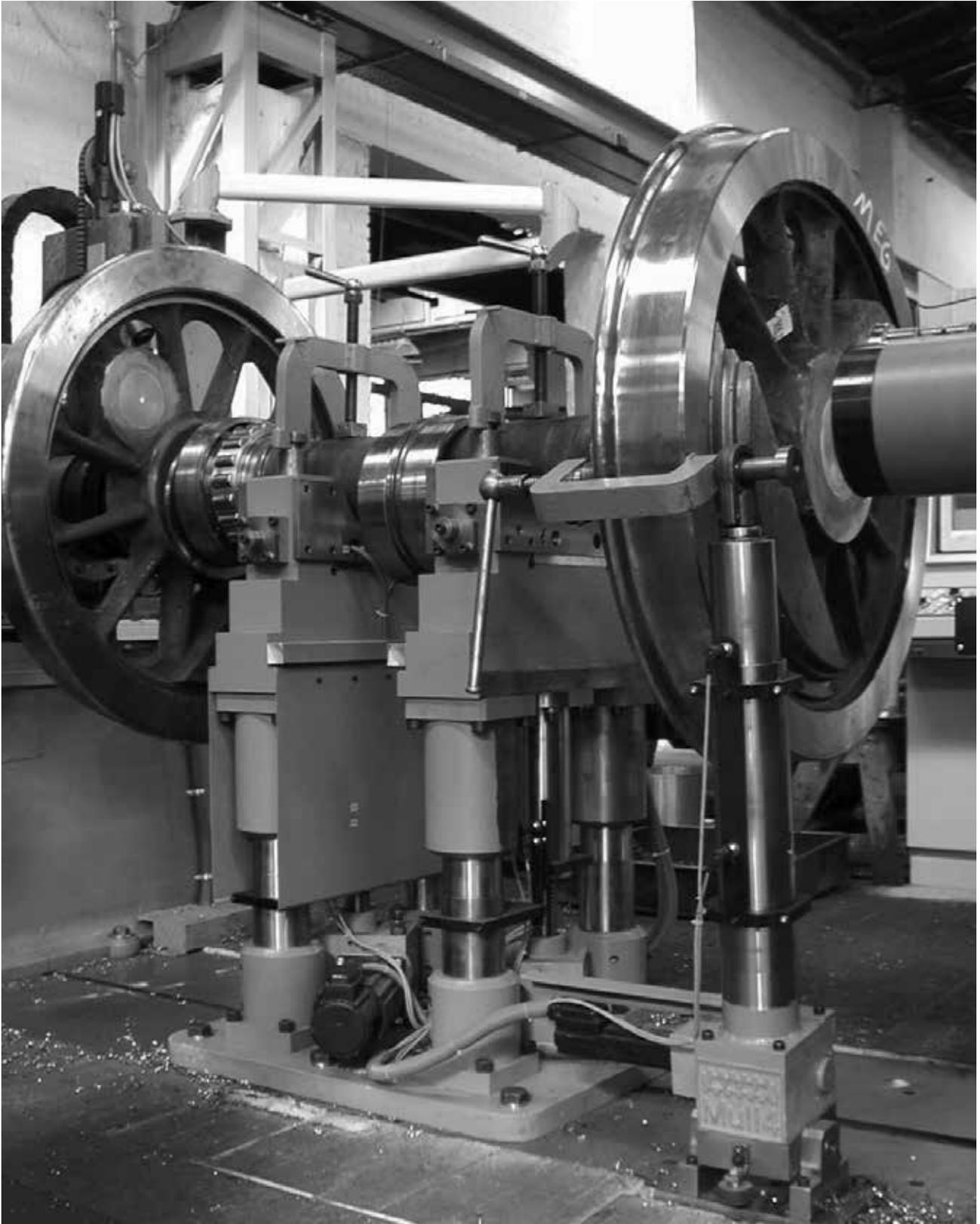
Vermessung von Radsätzen für Stangenlokomotiven, Fa. Hörmann Bahntechnik
