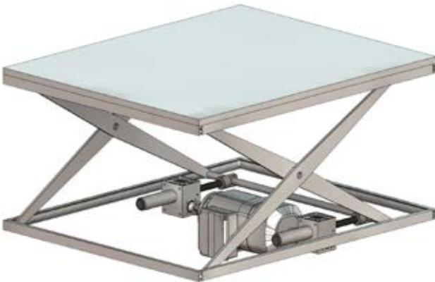
Vier Spindelhubgetriebe in unterschiedlicher Ausführung werden durch einen Motor angetrieben
