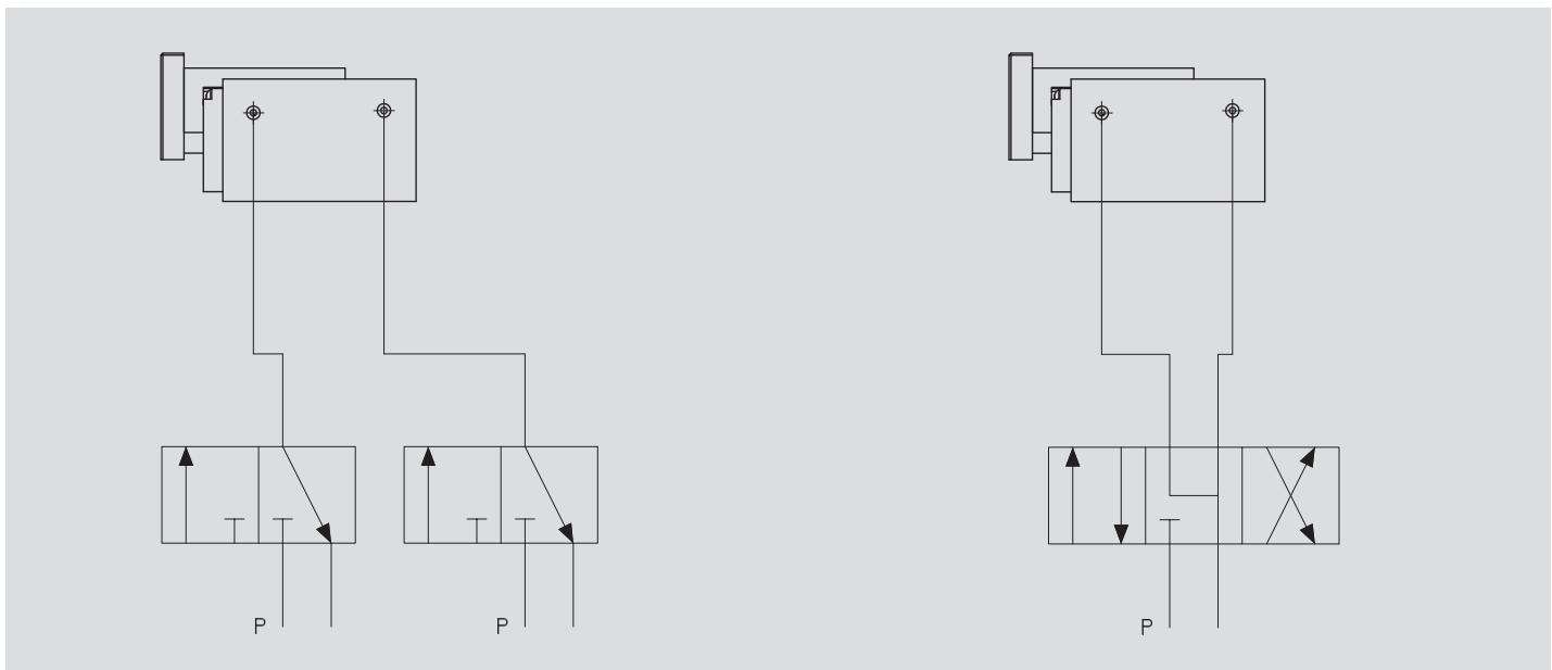
Der Eckdämpfer kann auch mit zwei Ventilen (oder alternativ mit einem 4/3-Wegeventil) angesteuert werden, um den Anschlag ohne Vortriebskraft in die Endlage zu bringen (doppeltwirkender Betriebsmodus).
